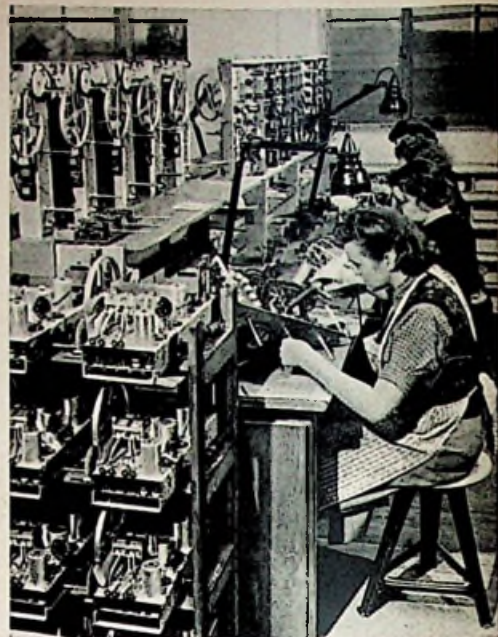
Chassis reiht sich an Chassis. Die letzten Lötungen verbinden das am Schluß der Bandmontage eingebaute Schalteraggregat mit dem Chassis
