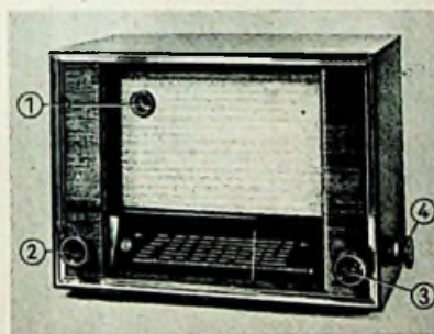
① Magisches Auge, ② Lautstärkeregl. mit Netzschalter, ③ Senderabstimmung, ④ Wellenbereichschalter
